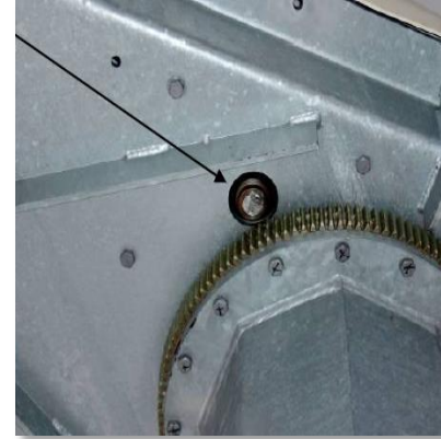
暴风导致双轴跟踪系统齿轮损坏
